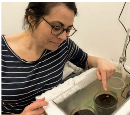
Mercè Berga Quintana untersucht die Sauerstoffzehrungsraten in Sedimenten aus dem Gotland-Tief. Foto: Kube, IOW
