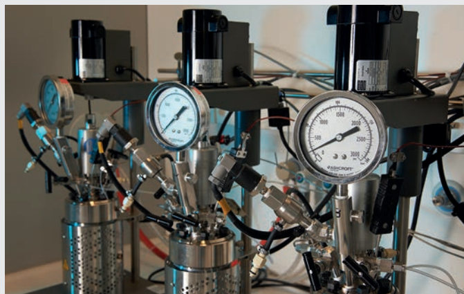
Utensilien aus der „Laborküche“: Ofen zum Aufheizen unterschiedlicher Substanzen (links) und drei Autoklaven für Reaktionen, die unter Druck stattfinden. Fotos: nordlicht, LIKAT
