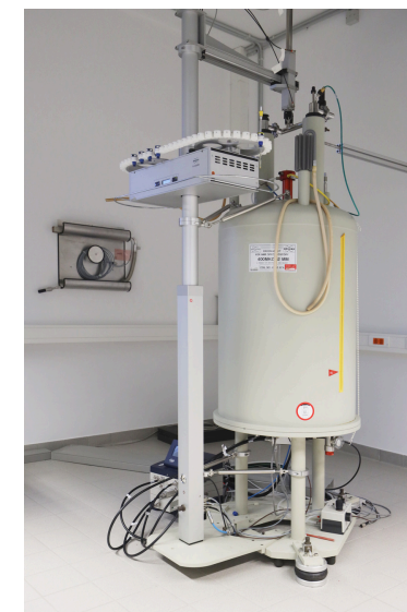
links: 400 MHz-NMR-Gerät von Bruker für die Routine-Analytik
