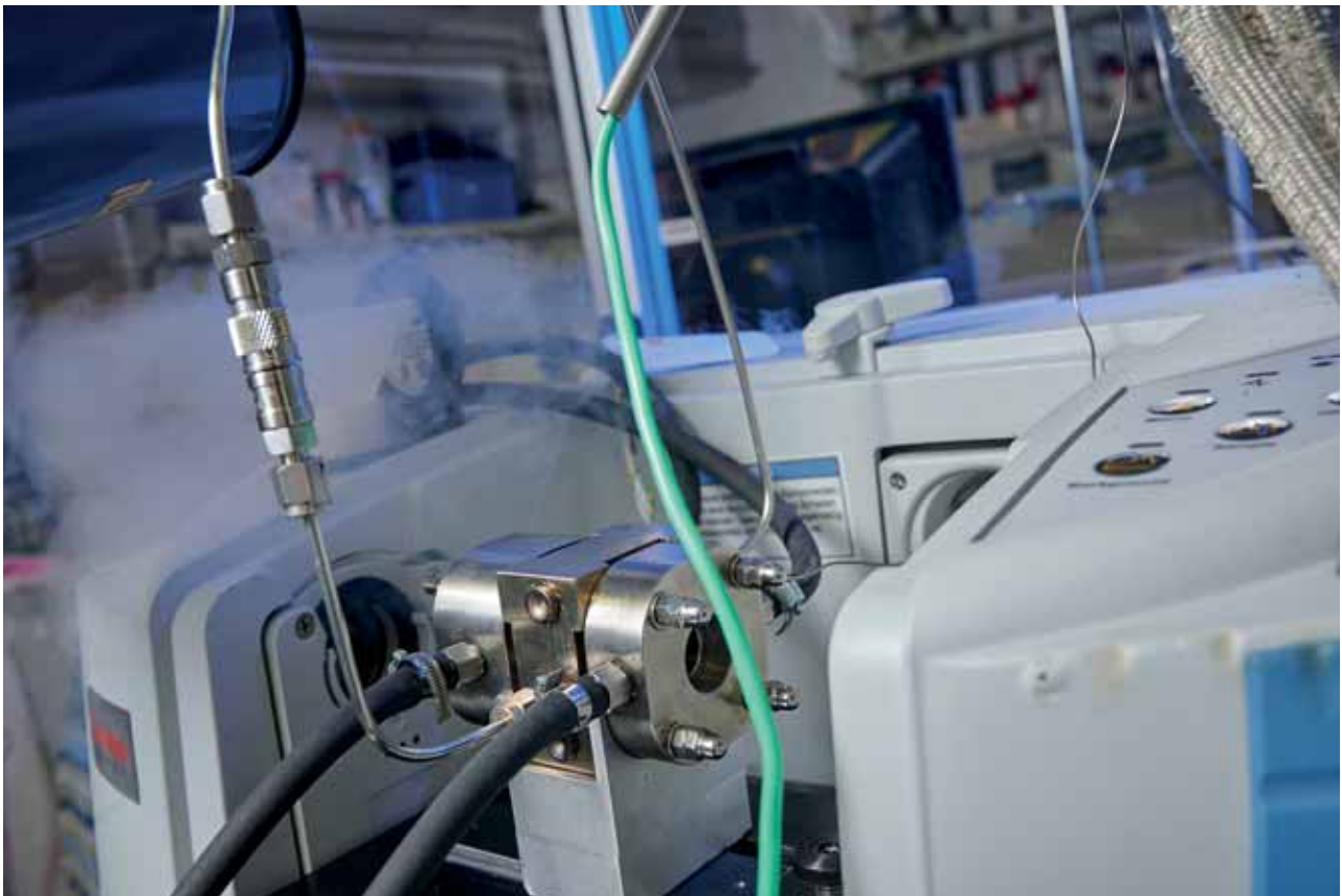
Am LIKAT entwickelte Zelle zur Untersuchung von Katalysatoren mittels operando -FTIR-Spektroskopie unter Druck.
